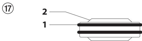
15. För den undre packningen till sitt ändläge med hjälp av monteringsverktyget.
